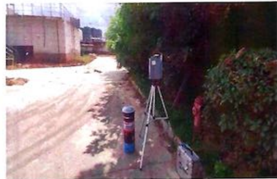
厂界 2# (○2) 无组织排放废气监测点
